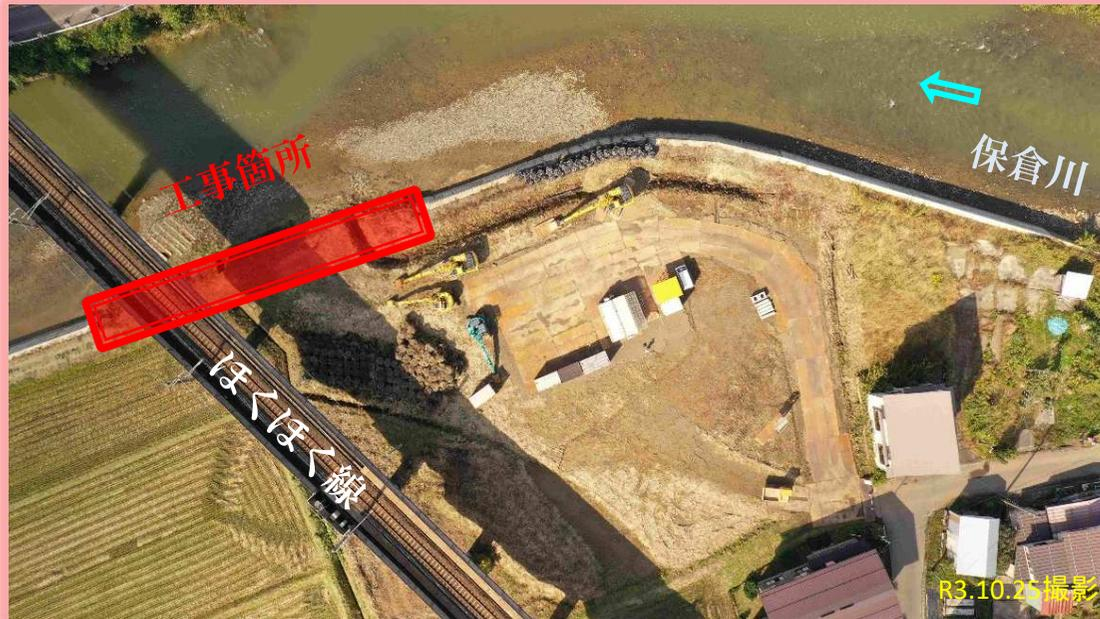
樋門と護岸を整備し、すでに完成している部分とを繋げます。
